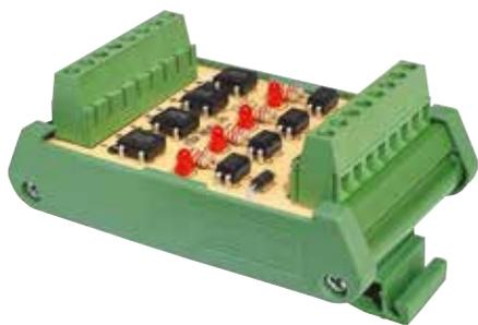
**Описание** В ПЛК или микропроцессорных системах он защищает процессор и ПЛК, электрически изолируя электронную схему от цепи питания. Эта плата используется как вход микропроцессора, а выход имеет 4 канала. Он изолирован в обеих цепях. Работа сопровождается светодиодом
