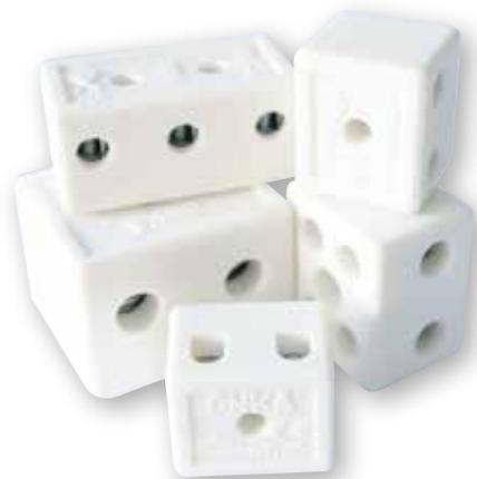
стеатит; Используется в производстве изоляционных деталей, имеющих более высокую электрическую и механическую прочность, чем обычные фарфоровые материалы.
